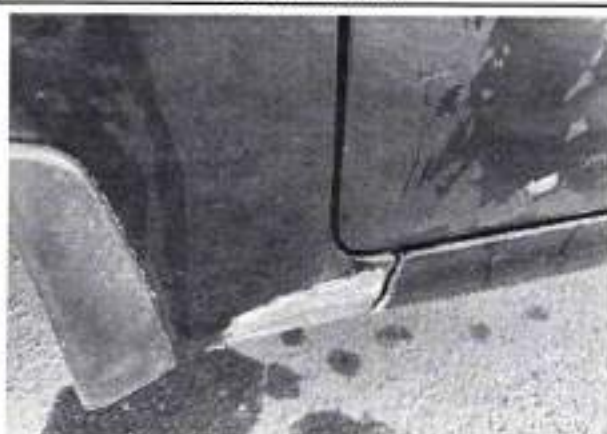
Крыло переднее левое - очаги коррозии
